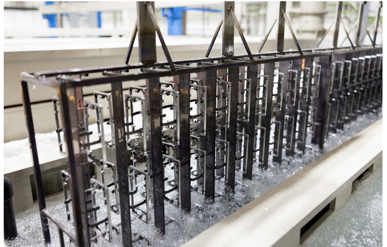
Das Eloxieren von Aluminium ist normalerweise ein wasserintensiver Prozess. 2019 haben wir ein Pilotprogramm gestartet, um die Einleitung gefährlicher Abwässer zu vermeiden und die Wassereffizienz beim Eloxieren zu erhöhen. Die Kaskaden- und Gegenstromspülverfahren, die dazu beigetragen haben, 75 bis 85 % des bei der Metallveredelung verbrauchten Wassers einzusparen, könnten bei einer groß angelegten Anwendung jährlich Millionen von Litern Frischwasser einsparen.
