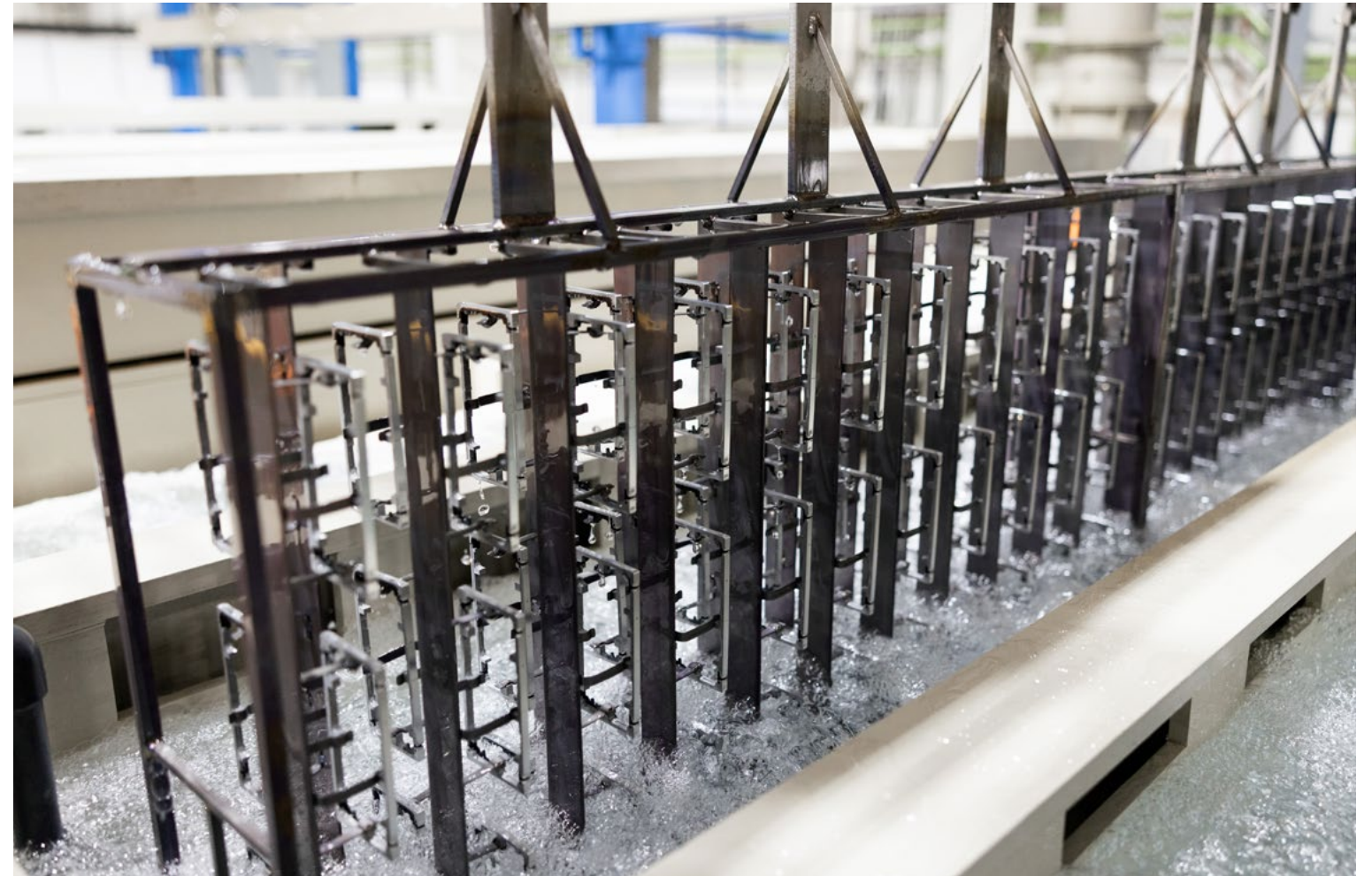
Le processus d'anodisation de l'aluminium consomme généralement beaucoup d'eau. En 2019, nous avons lancé un projet pilote visant à éliminer les rejets potentiellement dangereux et à permettre un usage plus efficace de l'eau dans le cadre de l'anodisation. Appliqués à grande échelle, les processus de rinçage en cascade et à contre-courant, qui ont aidé à conserver 75 à 85 % de l'eau utilisée pendant la finition du métal, pourraient permettre d'économiser chaque année des millions de litres d'eau douce.
