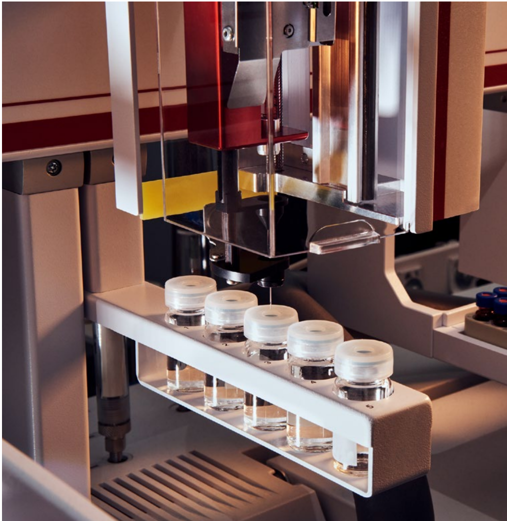
Nous évaluons dans les matériaux la présence de substances faisant l'objet d'une restriction dans notre Liste des substances réglementées, notamment les COV, à l'aide d'équipements tels que ce système de chromatographie gazeuse/spectrométrie de masse (CPG/SM).
